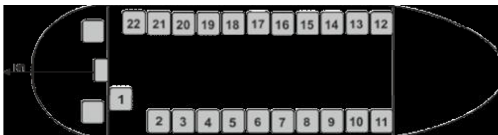
Рис 11. Схема расположения и нумерация пассажирских сидений на вертолете Ми-8Т в пассажирском варианте.
