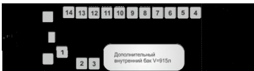
Рис 9. Схема расположения и нумерация пассажирских сидений на вертолете Ми-8Т в варианте с одним дополнительным топливным баком внутри фюзеляжа.
