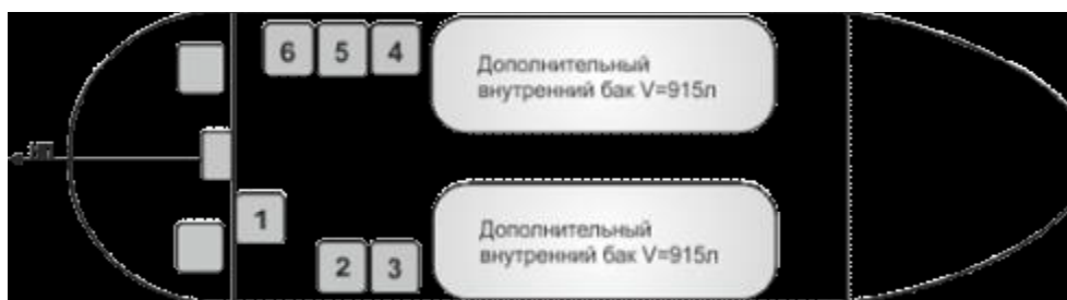
Рис 10. Схема расположения и нумерация пассажирских сидений на вертолете Ми-8Т в варианте с двумя дополнительными топливными баками внутри фюзеляжа.
