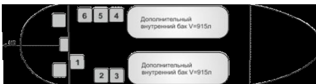
Рис 13. Схема расположения и нумерация пассажирских сидений на вертолете Ми-8 в варианте с двумя дополнительными топливными баками внутри фюзеляжа.
