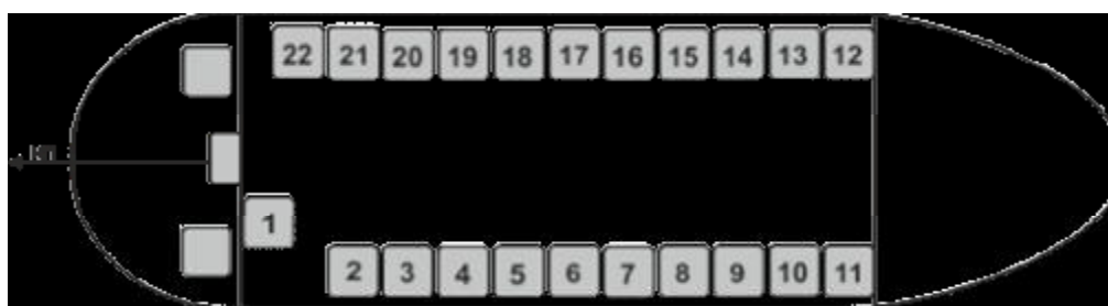
Рис 8. Схема расположения и нумерация пассажирских сидений на вертолете Ми-8Т в пассажирском варианте.
