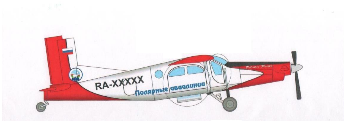
Рис.32 Схема размещения дверей воздушного судна PC-6/B2-H4
