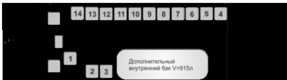
Рис 12. Схема расположения и нумерация пассажирских сидений на вертолете Ми-8Т в варианте с одним дополнительным топливным баком внутри фюзеляжа.
