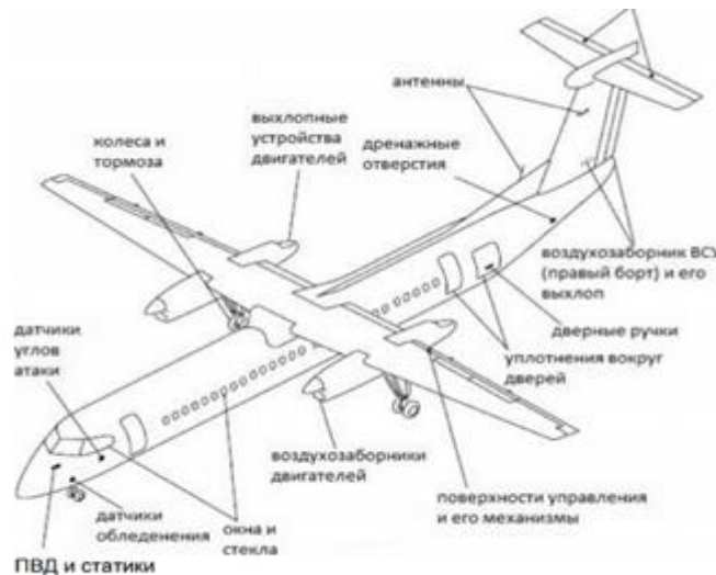
Рис. 97 Элементы ВС, на которые запрещено направлять струю ПОЖ.
