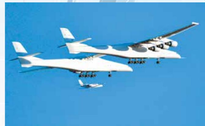
По данным New Atlas, трехчасовой полет самолета проходил над пустыней Мохаве, которая расположена на юго-западе США. Во время полета воздушное судно достигло максимальной высоты, наблюдавшейся за все время испытаний – 8200 м. Известно, что максимальный взлетный вес Stratolaunch Roc составляет 590 тонн с весом подвесной полезной нагрузки 230 тонн. Разработка самолета-гиганта велась с 2011 года.
