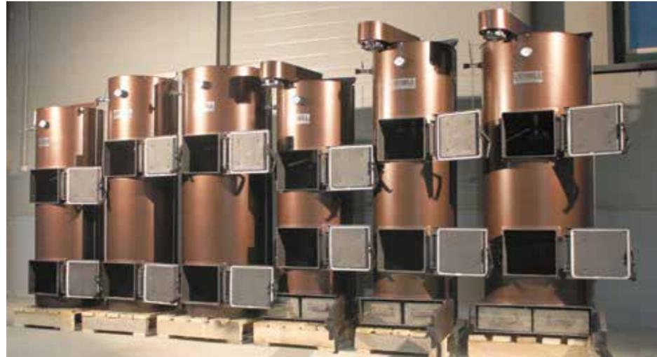
полена или топки угля. Для помпы требуется мало воды. Например, в большой котел наливают всего 40-50 л. Чтобы вода нагревалась быстро, «рубашку» делаем толщиной 1,5 см. По данному принципу изготовили в общей сложности около 2500-3000 котлов.
