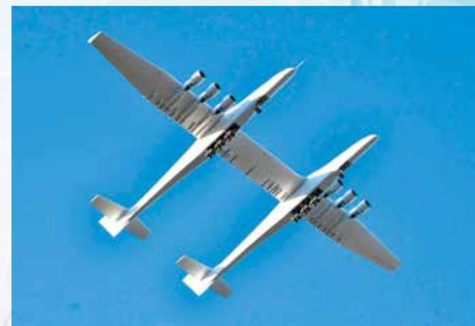
изначально проектировала Roc для доставки ракет и спутников в стратосферу, откуда они затем попадали бы на низкую околоземную орбиту. Недавний сдвиг в стратегии привел к тому, что массивный самолет с шестью двигателями Boeing, двумя расположенными бок о бок фюзеляжами и феноменальным размахом крыльев 117 метров был модернизирован в качестве носителя для гиперзвуковых исследовательских аппаратов.
