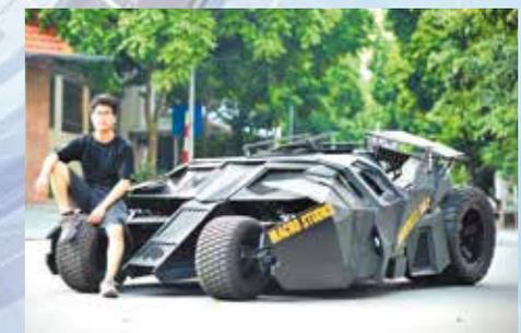
Аппарат работает только на электрическом движке. В наличии гидравлические двери с дистанционным управлением, четыре камеры с обзором в 360 градусов. Пулеметы, увы, нет. Зато в салон наряду с водителем поместится еще один пассажир.
