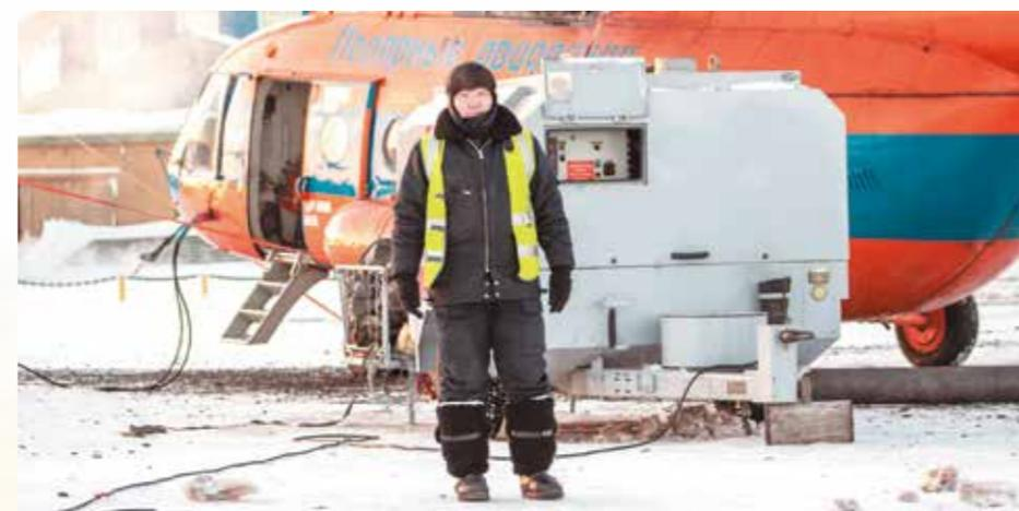
силовую установку. Снег выдувают, а затем еще два часа прогревают борт, чтобы вся влага испарилась.
