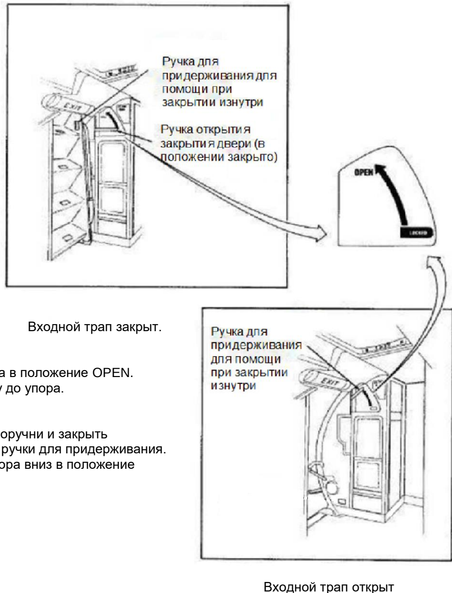
Рис.33 Открытие/закрытие переднего трапа-двери из салона самолёта.
